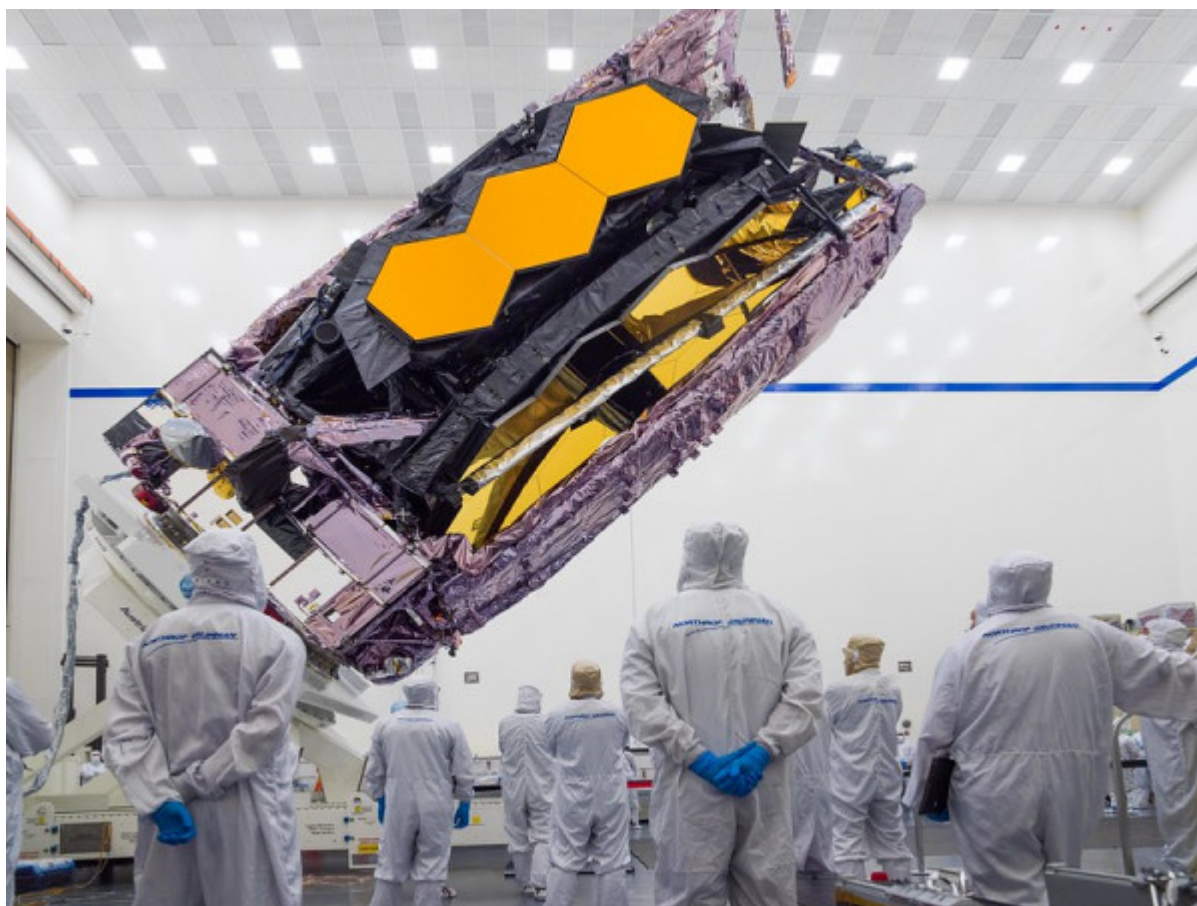
Για να χωρέσει στον πύραυλο το τηλεσκόπιο εκτοξεύτηκε με το κάτοπτρο διπλωμένο στα τρία (NASA/Chris Gunn)
