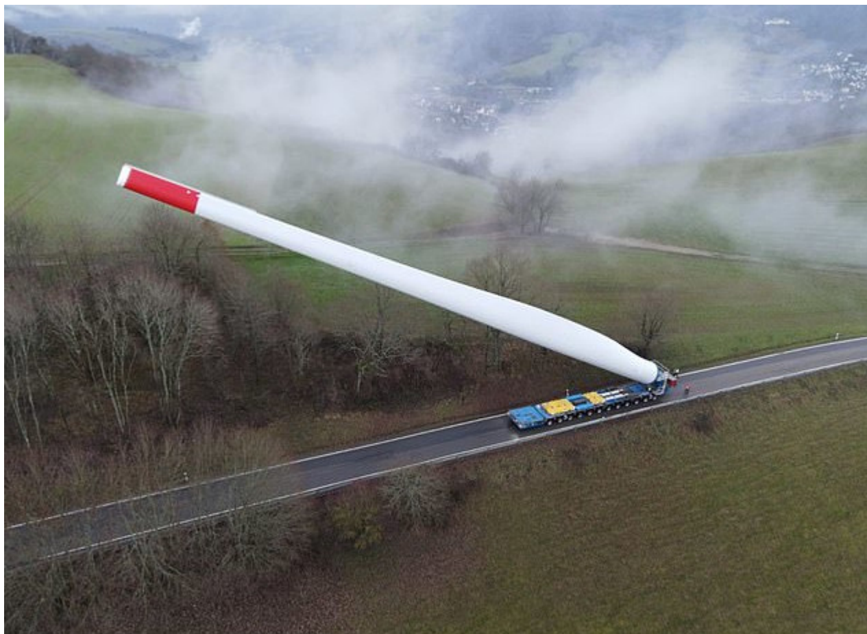
Η μεταφορά του πτερυγίου μήκους 67 μέτρων απαιτεί ιδιαίτερες δεξιότητες
