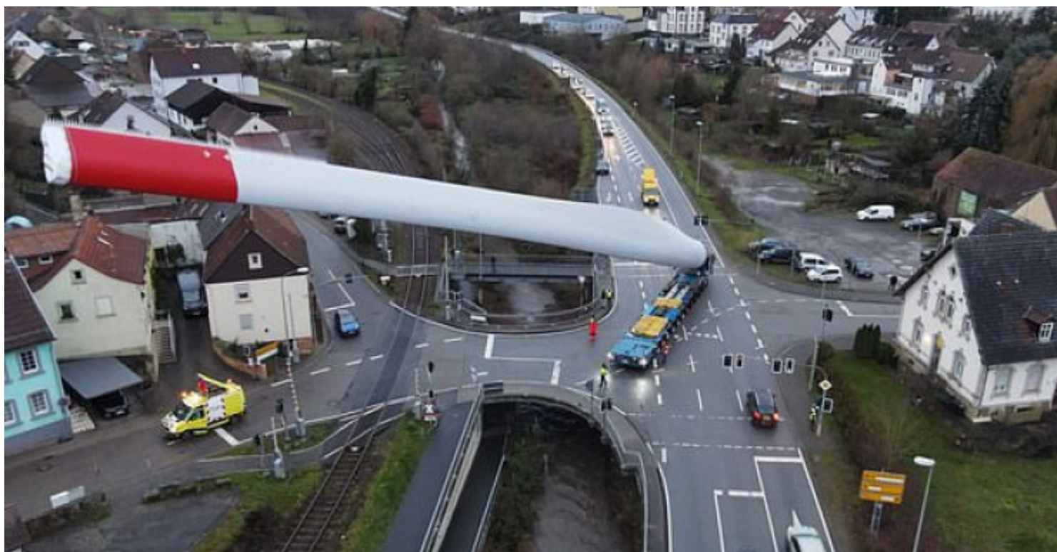
Η μεταφορά ενός πτερυγίου ανεμογεννήτριας μέσα από μια πόλη/Φωτογραφία: LinkedIn/ P. Adams Schwertentransporte
