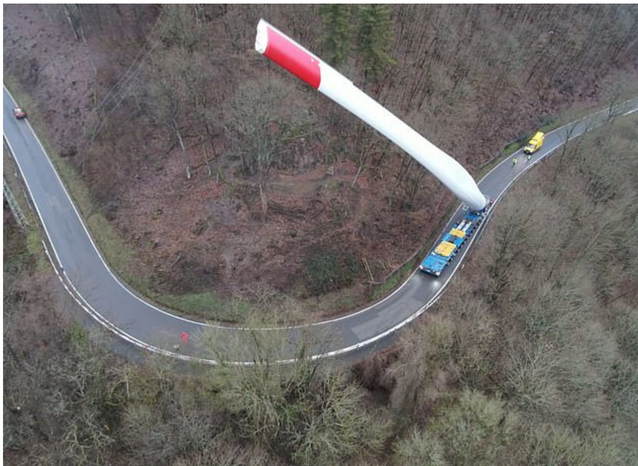
Τα πτερύγια μεταφέρονται ολόκληρα καθώς δεν μπορούν να αποσυναρμολογηθούν
