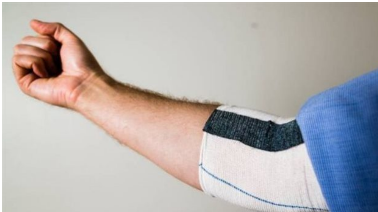
Οι ερευνητές έδωσαν στην δημοσιότητα μια εικόνα ενός ενδύματος με υφασμάτινο τεχνητό μυ. Credit: Thor Balkhed/Linköping University
