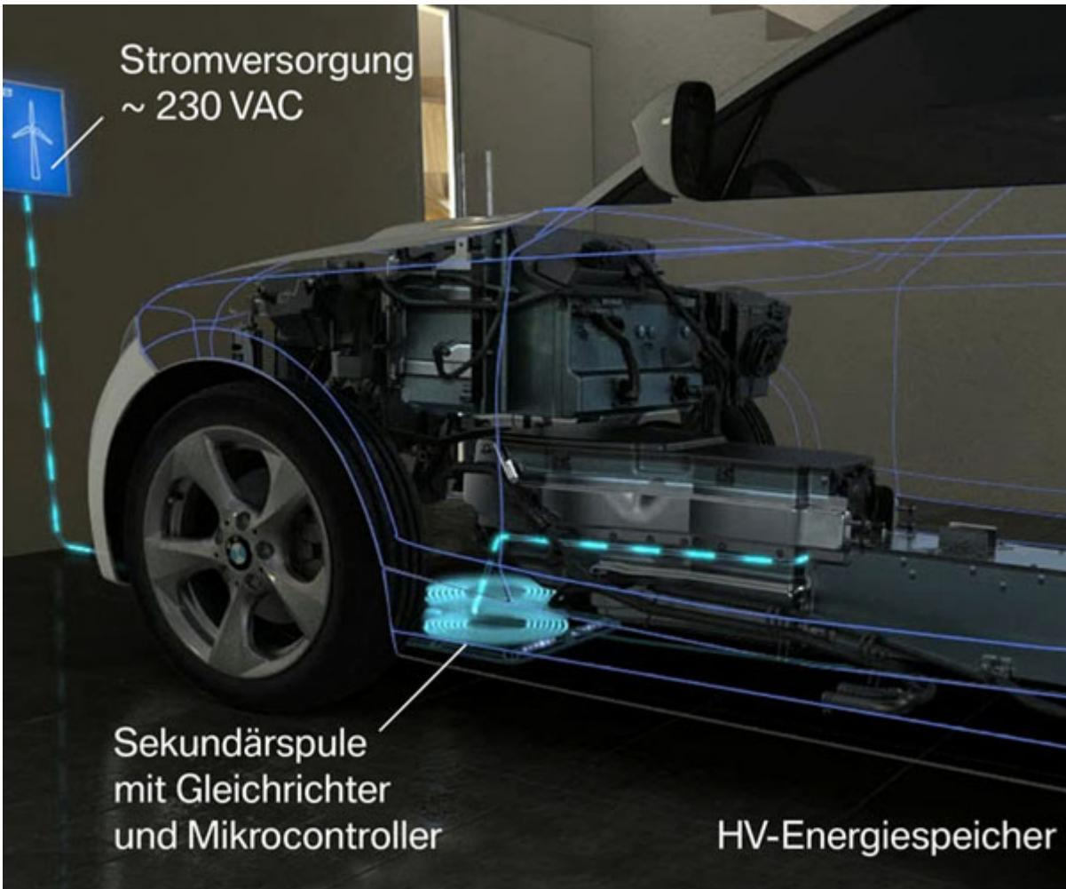
**Τα συστήματα για επαγωγική φόρτιση μπαταριών υψηλής τάσης είναι το επόμενο βήμα εξέλιξης των ηλεκτρικών οχημάτων. Το σημαντικό πλεονέκτημα της επαγωγικής φόρτισης έναντι των συμβατικών λύσεων είναι η ασύρματη σύνδεση μεταξύ παροχής και μπαταρίας του οχήματος.**
