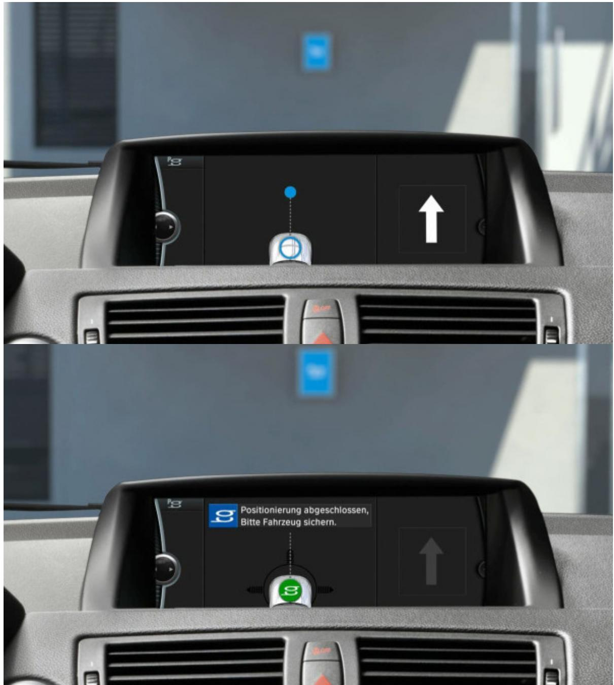
Η επαγωγική φόρτιση κάνει ευκολότερη τη ζωή του οδηγού ενός ηλεκτρικού (ή plug-in υβριδικού οχήματος), καθώς δεν απαιτείται σύνδεση καλωδίων φόρτισης. Μόλις παρκάρει ακριβώς πάνω από το πρωτεύον πηνίο, ο οδηγός μπορεί να ξεκινήσει τη διαδικασία φόρτισης πιέζοντας ένα μπουτόν χρησιμοποιώντας το λειτουργικό σύστημα του οχήματος. Τα δεδομένα μεταδίδονται μέσω μιας σύνδεσης WiFi μεταξύ οχήματος και σταθμού φόρτισης για υποστήριξη του οδηγού ακόμα και όταν παρκάρει.
